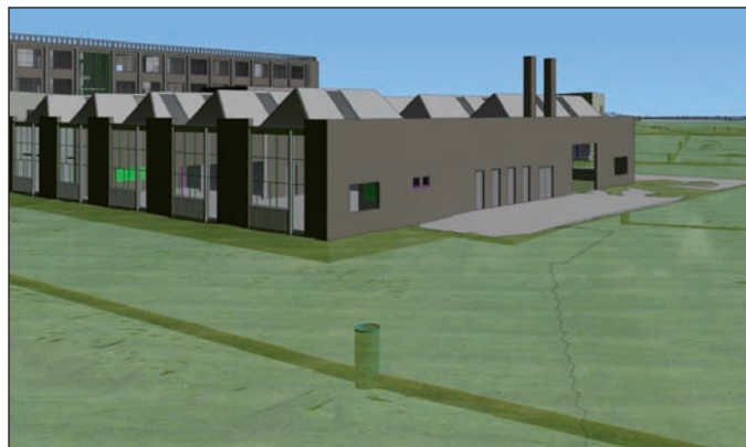
Afbeelding 4: Combinatie van BIM, Terreinmodel en riolering.
